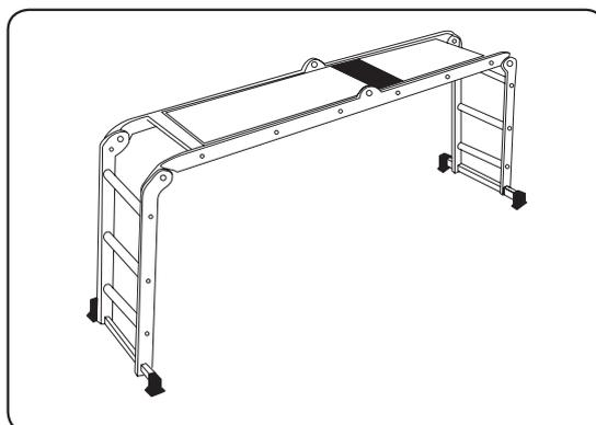
Om het opbergen te vereenvoudigen kan het platform binnenin de opgevouwen ladder geplaatst worden.
